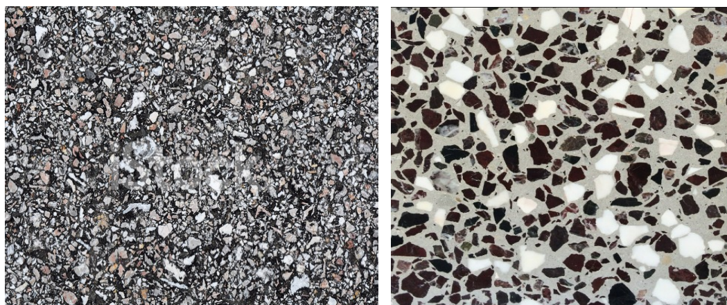
1-rasm. Rangli to‘ldiruvchi asosidagi rangli asfalt-beton namunalari [4].
