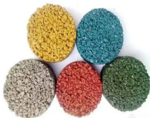
1.2-rasm. Shaffof polimer bog‘lovchilar a) epoksid smola asosidagi b) kompleks polimer bog‘lovchi asosidagi rangli asfalt-betonlar [6].
