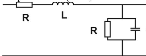
Рис. 3 Упрощенная эквивалентная электрическая схема витой пары
