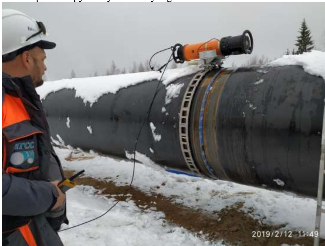
Рис. 1. Объект «Развитие газотранспортных мощностей ЕСГ Северо-Западного региона, участок Грязовец – КС Славянская февраль 2019 г. Цифровой комплекс «Транскан» готов к работе.
