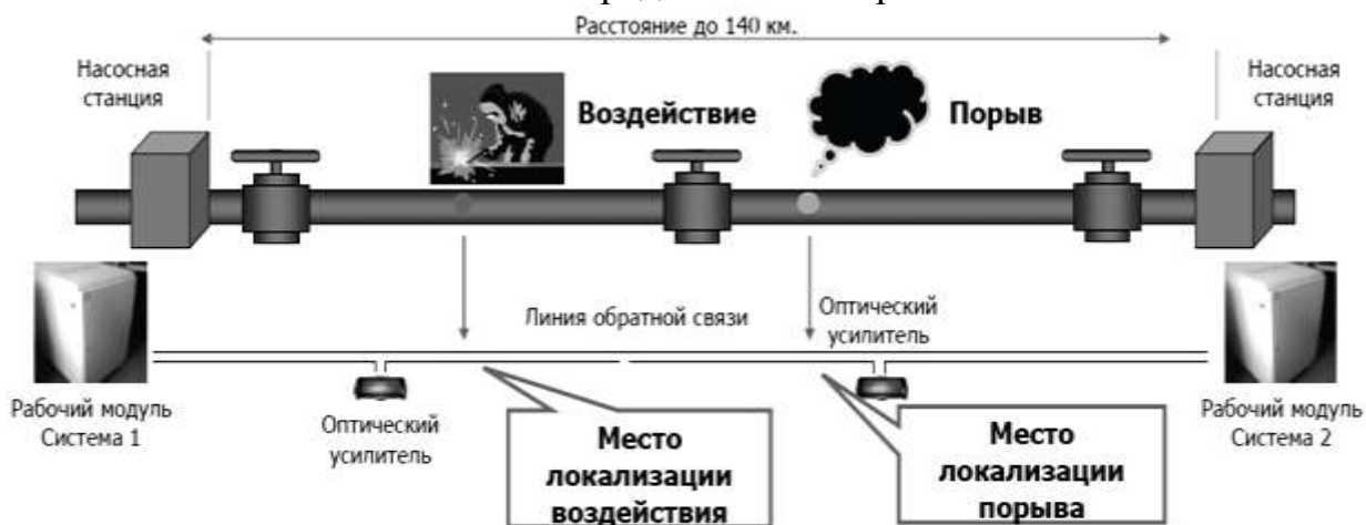
Рис. 3. Конструкция системы ВОС на трубопроводе
