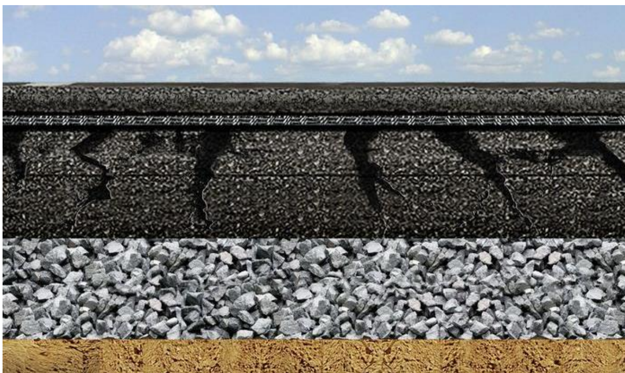
Рисунок-2. Процесс использования георешетки в конструктивных слоях дорожных одежд.
