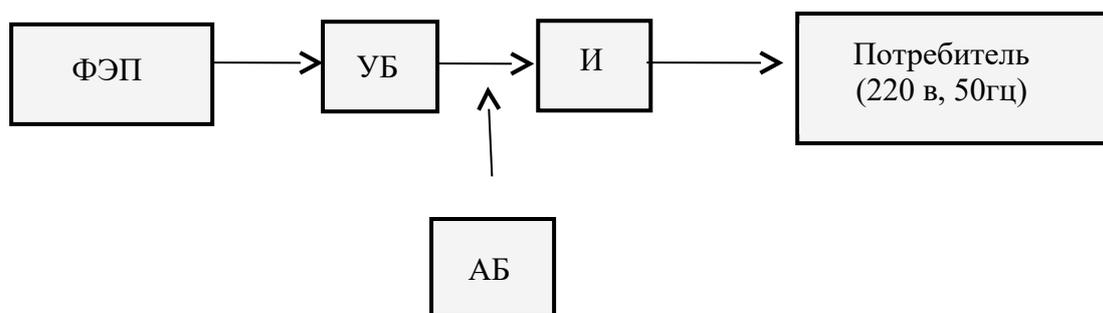
1-рис. Основные части фотоэлектрических установок.
