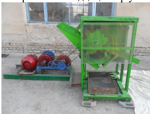
1-расм. Сўта қобикларини титилиш жараёнини ўрганиш учун лаборатория стенди
