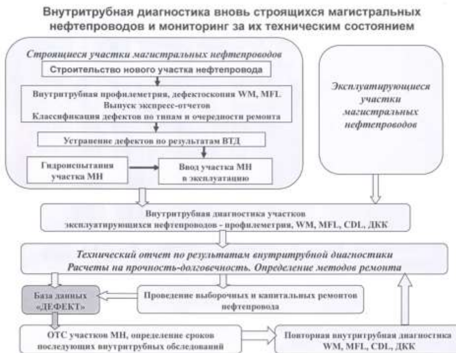
Рисунок 1.1 Схема внутритрубной диагностики вновь строящихся магистральных нефтепроводов и мониторинга за их техническим состоянием.
