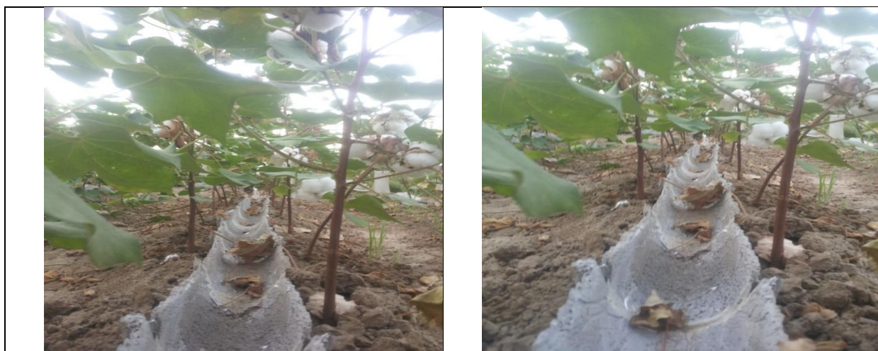
Рис.4. Практическое применение полученного пористого материала из фосфогипса для снижения поливной нормы.
