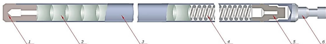
1-rasm. RBMK reaktorining yoniq'g'i tayoqchasi: 1 - vilka, 2 - yoniq'g'i pelleti, 3 - g'ilof, 4 - buloq, 5 - vtulka, 6 – uchi.
