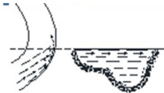
2- rasm. Botiq qirg'oq yaqinidagi reaktivlarning yo'nalishi. a-planda, b-ko'ndalang kesimda
