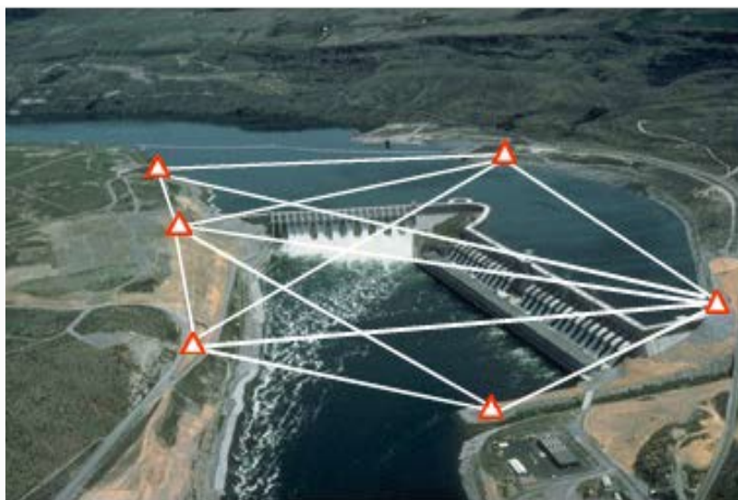
Рис. 1. Каркасная сеть спутниковых базовых станций на территории плотины.
