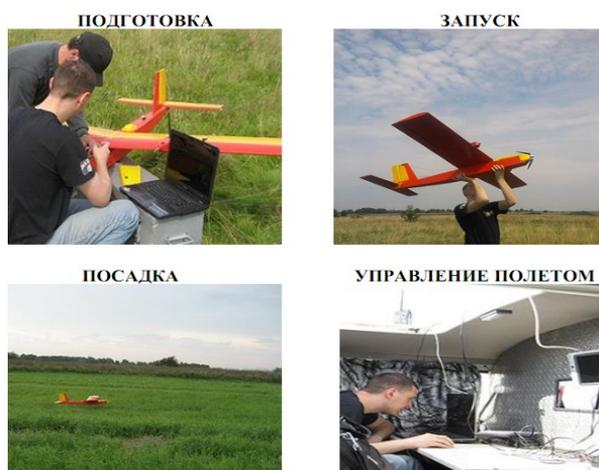
***Рисунок 6. Выполнение аэрофотосъемки с помощью беспилотного летательного аппарата***
