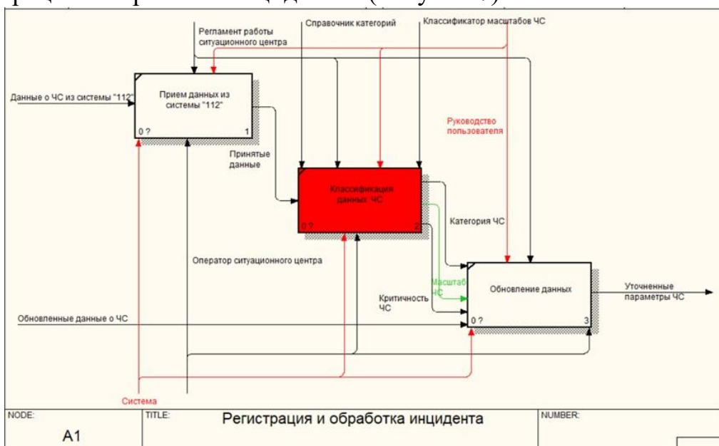
Рисунок 7 - Декомпозиция функционального блока «Регистрация и обработка инцидента» Исходя из вышеописанного, можно сделать вывод о том, что был автоматизирован блок «Классификация данных ЧС».
