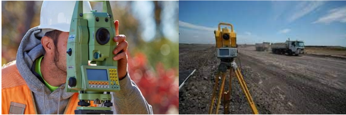
Рис.2 Процесс измерения электронным тахеометром
