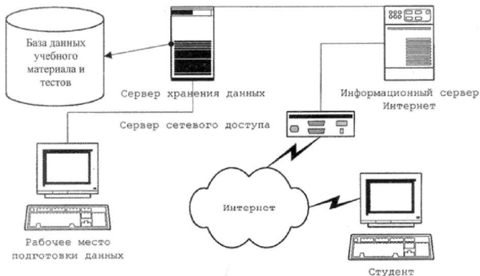
Рис. 3. Схема организации телекоммуникационного взаимодействия между серверами и рабочими станциями преподавателя и студента
