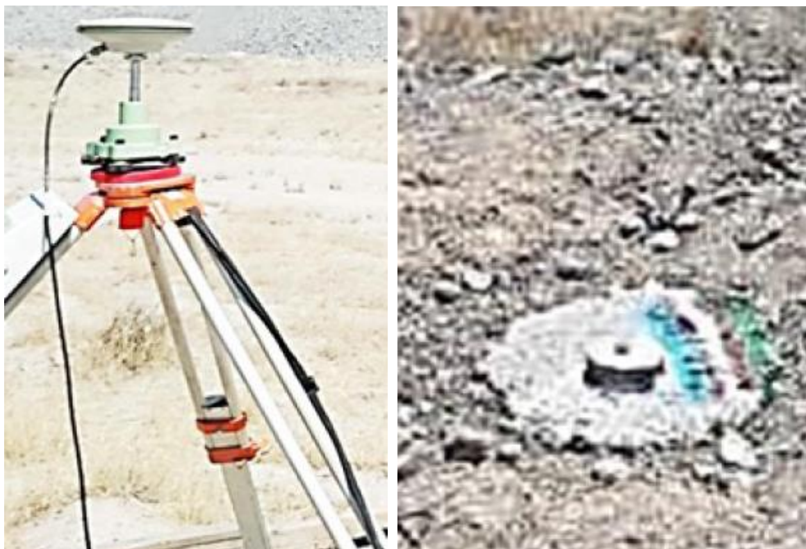
Рисунок 7 – Спутниковый геодезический пункт сгущения
