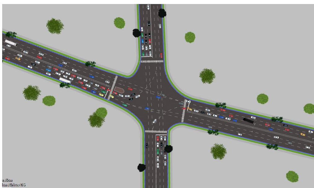
Рис.2. Цифровой двойник текущего состояния исследуемого перекрестка
