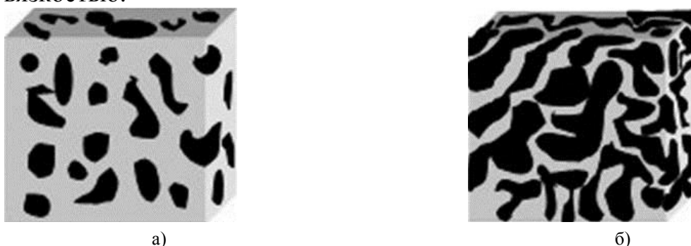
Рис. 1– Схемы фазовой структуры двухфазных смесей полимеров а) – обычная дисперсия; б) – структура с двумя непрерывными фазами
