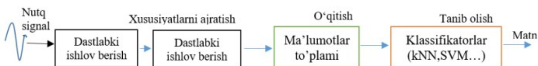
2-rasm. Nutqni tanib olish tizimining umumiy blok-sxemasi
