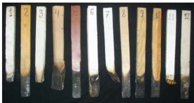
Рис. 1. Состояние образцов после испытания на горение.
