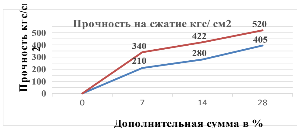
Рисунок 1. Влияние суперпластификатора «Бетон Стронг 17» на свойства портландцемента.
