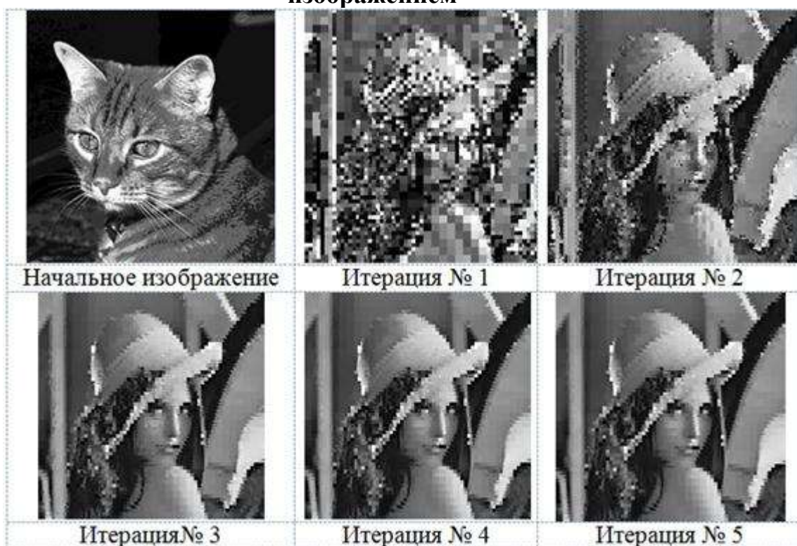
Рис. 3. Декодирование изображения с произвольным начальным изображением
