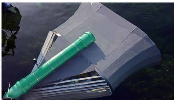
Рис.3. Общий вид погружной гидротурбины с общим направляющим соплом [8]
