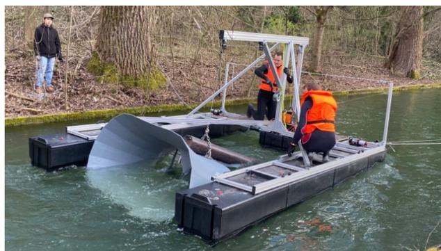
Рис.2. Общий вид пико турбины на понтонной основе.
