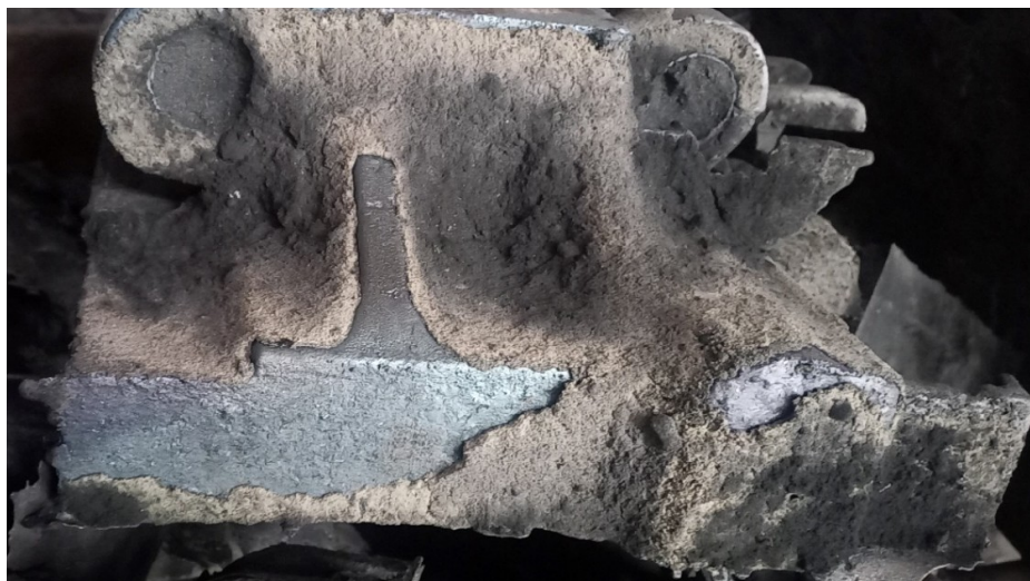
1-rasm. Po'lat quyma mahsulotlarda termik kuyishning hosil bo'lishi.
