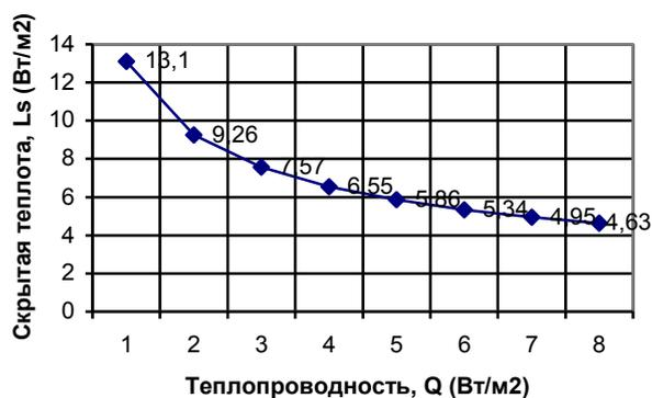
Рис.2. График расчетных значений скрытой теплоты в зависимости от мощности излучения
