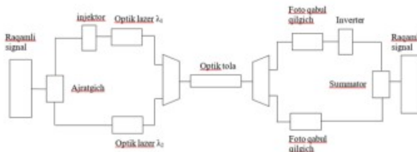
4-rasm. Bitta optik tola orqali raqamli signallarni ikkiga ajratib uzatish prinsipial sxemasi.
