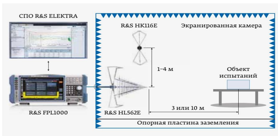
Рис. 3. Схема измерительной установки для анализа эмиссии излучаемых радиопомех в диапазоне частот от 30 МГц до 1 (6) ГГц при использовании ПО R&S ELEKTRA.
