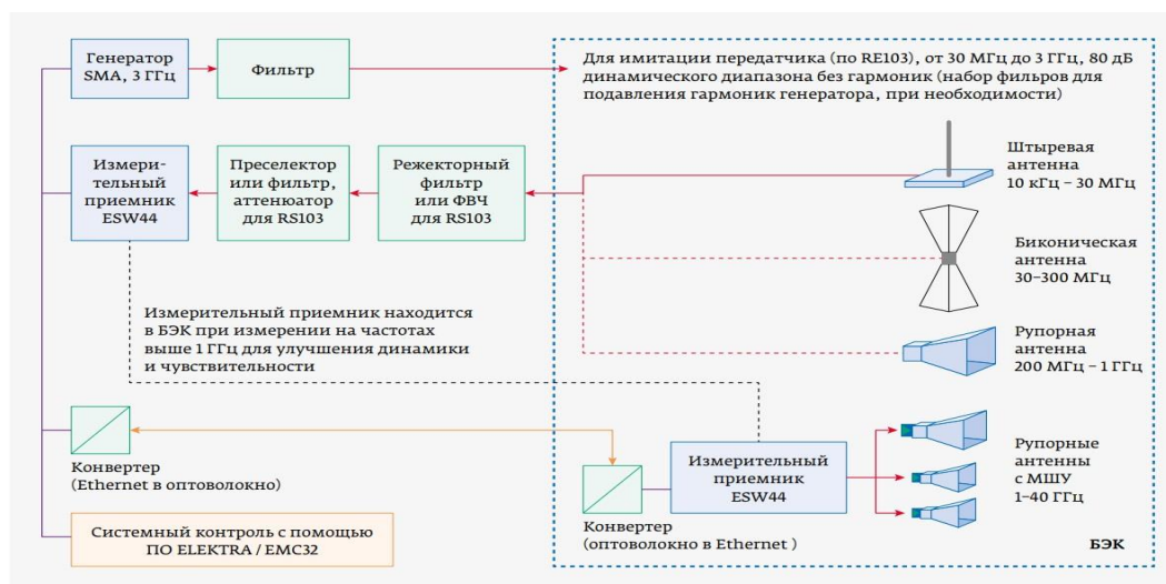
Рис. 4. Схема автоматической измерительной установки для анализа помехоэмиссии в диапазоне частот от 10 кГц до 40 ГГц при использовании ПО R&S ELEKTRA. RS103, RE103 – разделы стандарта MIL-STD-461
