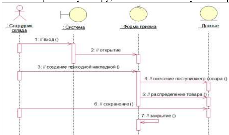
Рисунок 4 – Диаграмма последовательности варианта использования «Прием товара»
