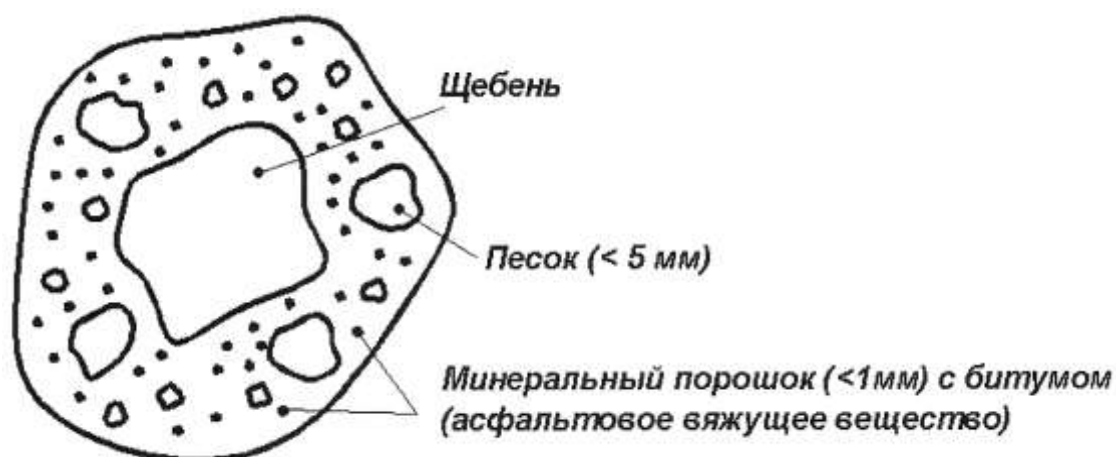
Рисунок 1. Структура гранулы асфальтобетона после фрезерования покрытия
